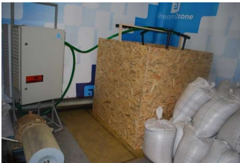
Рис. 5.7. Вигляд прототипу силосу для 1000 кг пшениці.
