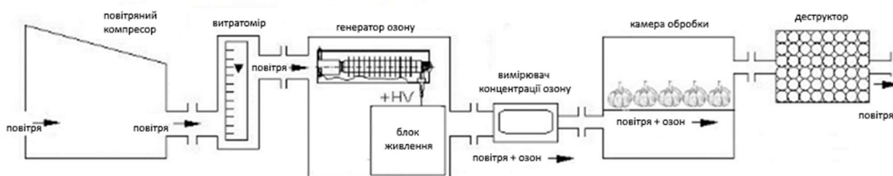
Рис. 5.14 Структурна схема функціональних блоків лабораторного стенду «Ozone-agro 1L».
